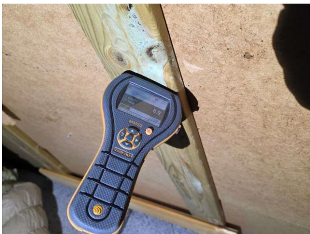
Bild 3: - Utvändigt, Grundmur/Hussockel, Krypgrund, se riskanalys Inga förhöjda fuktvärden uppmättes i grund.
