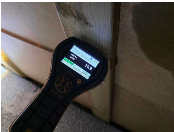
Bild 1: - Utvändigt, Grundmur/Hussockel, Krypgrund, se riskanalys Inga förhöjda fuktvärden uppmättes i grund.
