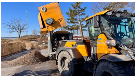
Sandupptagning och återanvändning av densamma.
